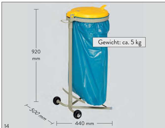
Abb.: Abfallsammler WSR 120, fahrbar. Zwei Rollen. Praktischer Bügelgriff und Halterung, die ein Wegrutschen des Abfallsackes beim Verfahren des Gerätes verhindert. Deckel gelb. Lieferung zerlegt. Einfache Selbstmontage. Art.-Nr.: 1640
